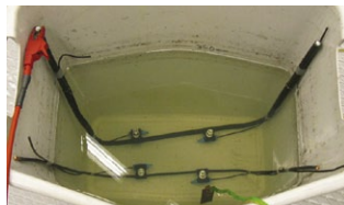
Диэлектрические испытания в воде
